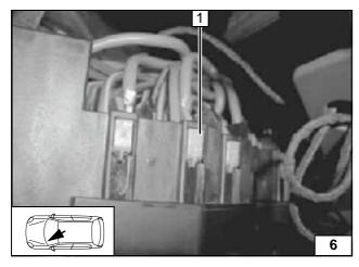
KS4 mit der fahrzeugeigenen oberen Schraube 1 am Sicherungshalter befestigen.
