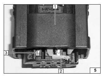
6-poligen Stecker X14 (1) vom Heizgerät abziehen. Leitung gelb von Kabelstrang 1 (KS1) in Steckplatz Pin 1 des Steckers X14 (1) einrasten. Stecker X14 (1) auf Heizgerät aufstecken.
